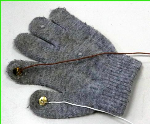
Die Reißzwecken sollen die Kontakte sein, womit der Handschuh den Elektromagneten an- und ausschalten kann. Einer der Drähte läuft zur Stromquelle und der andere zum Magneten, der sich so an- und ausschalten lässt.
