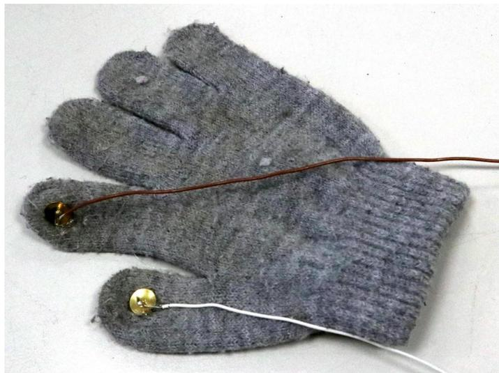
*Kontakte zum Einschalten des Magneten (Foto: Dück)*
